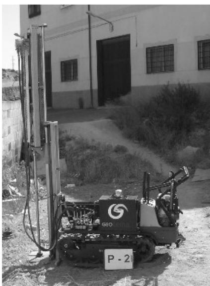
La resistencia a la penetración se define como el nº de golpes requerido para hacer avanzar el penetrómetro una longitud de 20 cm. designándose a este valor como  $N_{20}$ , representándose los resultados en gráficos que reflejan los diferentes golpes obtenidos en función de la profundidad. El ensayo se da por terminado cuando se alcanza el rechazo R, que fijamos en un valor de  $N_{20} = 100$  golpes.
