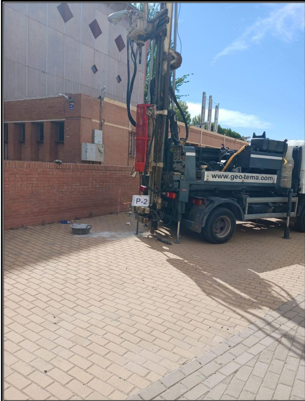
**Ensayo de penetración DPSH-2**
