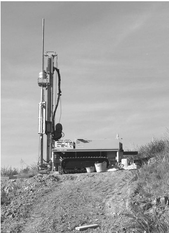
Las sondas son maquinarias de motricidad autónoma o más generalmente montadas sobre camión, cuyo funcionamiento generalmente es de tipo hidráulico, encontrándose constituida por un grupo generador (o toma de fuerza), una torre con una cabeza de rotación y una bomba de lodos para refrigeración de las coronas de corte. Adicionalmente cuentan con sistemas manuales o automáticos para la ejecución de ensayos de penetración y del material auxiliar para la perforación.
